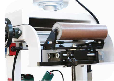
Kusursuz Folyo Yönlendirmeleri İçin Özel Olarak Tasarlanmış Kenar Kontrol Sistemi Special Foil Edge Control System for Perfect Routing
