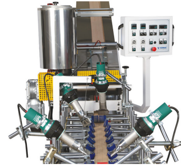
Tutkallanmış Malzemenin Ürüne Yapıştırıcılığını Arttıran Sıcak Hava Tabancaları The Hot Air Duster Guns is Increased the Adhesion of Glued Materials to the Product
